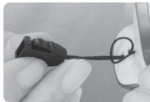
U kunt een riem bevestigen aan het toestel om de oximeter gemakkelijker te vervoeren. Laat het fijne uiteinde van de riem doorheen de drager glijden, zoals afgebeeld.
