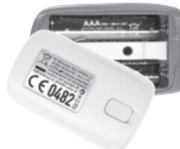
Jakmile na displeji začne svítit symbol slabé baterie, je jejich kapacita nedostatečná a je třeba je vyměnit. Do prostoru pro baterie vložte dvě baterie AAA, dbejte přitom na správnou polaritu +/- a nasadte kryt prostoru pro baterie.
