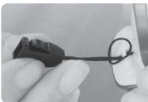
Sie können einen Riemen am Gerät anbringen, um das Pulsoximeter auf diese Weise einfacher zu transportieren. Führen Sie das schmale Ende des Riemens durch das Gerät, wie auf der Abbildung dargestellt. Ziehen Sie das andere Ende des Riemens durch die Öse des schmalen Endes gut fest.
