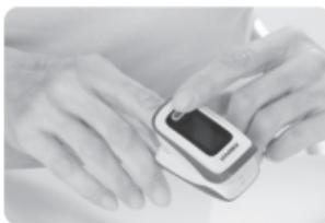
Vsuňte celý prst do části oxymetru sloužící k měření. Plochu nehtu směřujte nahoru, potom uvolněte poutko. Stisknutím tlačítka napájení oxymetr zapněte.
