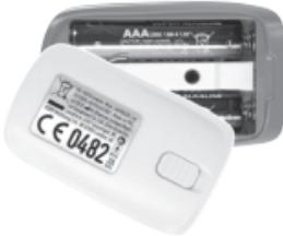
Die Batterien sollten gewechselt werden, sobald ihre Leistungsfähigkeit abnimmt und das Symbol auf dem Bildschirm blinkt. Setzen Sie zwei AAA-Trockenbatterien im Batteriefach ein, gemäß der Polaritätsanzeige und montieren Sie anschließend den Batteriedeckel.
