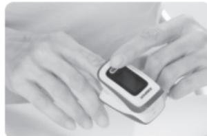
Führen Sie einen Finger komplett in die Messeinheit des Oximeters ein. Halten Sie die Nageloberfläche nach oben und lassen Sie den Clip los. Zum Einschalten des Oximeters den Ein-/Aus-Schalter drücken.
