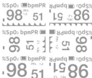
Během monitorování podržte stisknutý vypínač. Monitorovaná data a režim zobrazení se budou cyklicky zobrazovat na OLED obrazovce dvěma různými způsoby (velká písma a pletysmogram) a ve čtyřech směrech, jak je znázorněno na obrázku.
