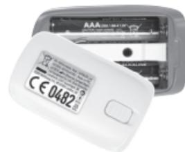
Vervang de batterijen wanneer hun vermogen ontoereikend is en het symbool knippert op het scherm. Installeer de twee droge batterijen AAA in het batterijvak volgens de aangeduid polariteit en monter het deksel van de batterij.
