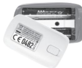
Remplacez les piles lorsque leur capacité est insuffisante et que le symbole clignote à l'écran. Installez les deux piles sèches AAA dans le logement de la batterie conformément à l'indication de polarité et montez le couvercle de la batterie.
