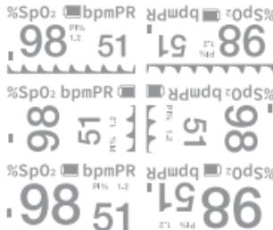
Hou de aan/uit-knop ingedrukt in het surveillanceproces. De bewaakte gegevens en de weergavemodus worden op twee verschillende manieren cyclisch weergegeven op het OLED-scherm (grote lettertypes en plethysmogram) en in vier richtingen, zoals afgebeeld in de figuur.
