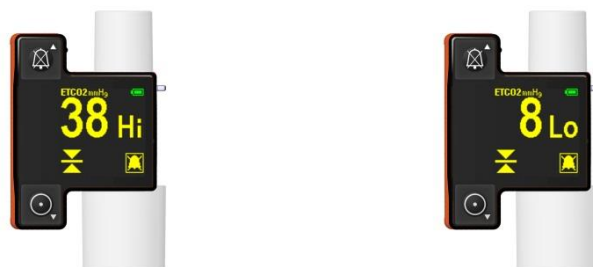
Figure 10. Réglage des seuils d'alarme ETCO 2 élevé et faible
