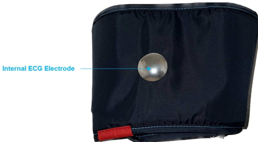
Image 2-3 : Electrode ECG intégrée dans le brassard
