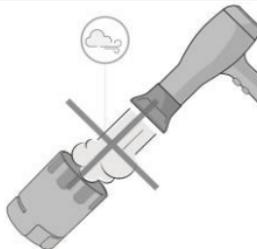
Le fonctionnement correct de la turbine est garanti uniquement si elle est « propre » et exempte d'objets étrangers affectant son mouvement. La présence de poussière ou de corps étrangers (tels que des poils, des expectorations, etc.) pourrait ralentir ou bloquer les parties mobiles de la turbine et compromettre la précision du résultat, ou endommager la turbine elle-même.
